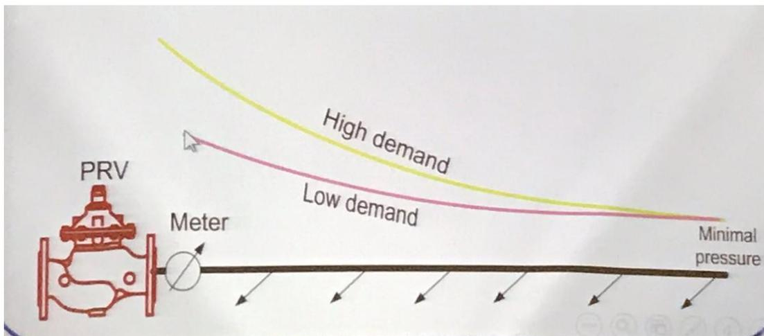
En el extremo izquierdo se muestra la válvula de acceso a la red, y en el extremo derecho el punto más alejado o de mayor elevación, donde debe garantizarse una presión mínima de 15 mca.
